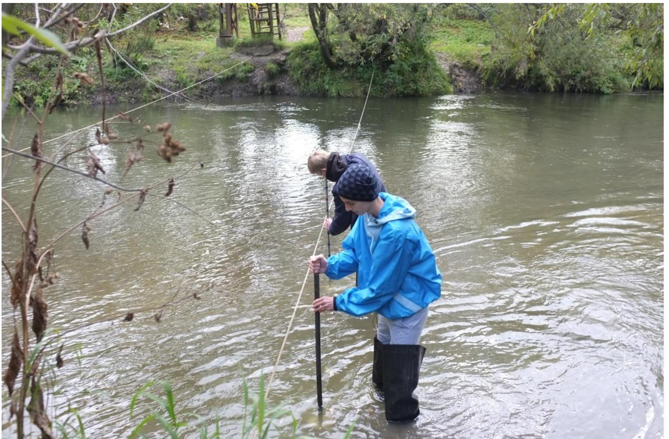
Вторая часть нашего задания состояла в том, чтобы измерить скорость течения реки и вычислить расход воды. Скорость течения измерялась с помощью поплавков. Вот как это происходило:
